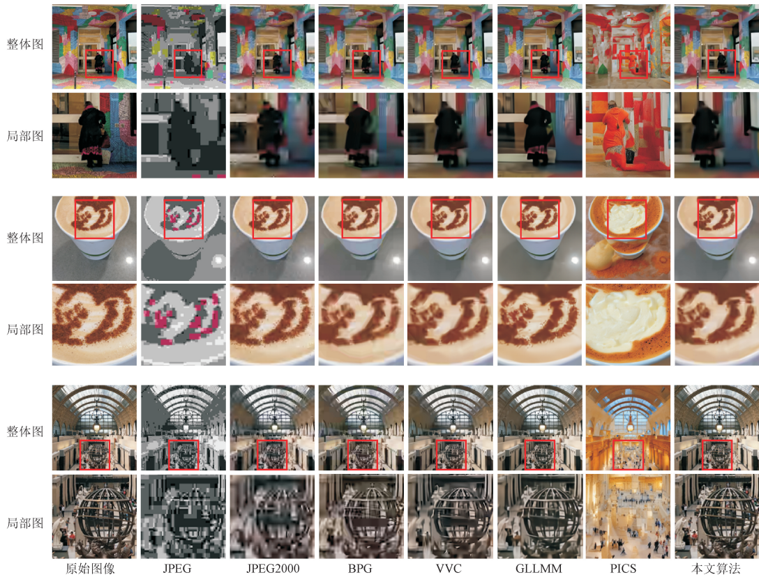
图 6 不同方法在相近码率范围内的高保真重建结果对比( B_{\text{pp}} \approx 0.1 )
